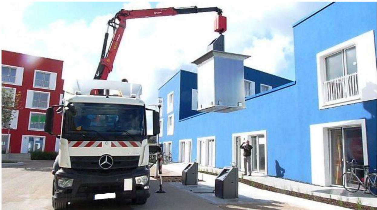
*Entnahme des Abfallcontainers aus dem Unterflursystem durch ein Entsorgungsfahrzeug mit ausgefahrenen Stützfüßen. <sup>(4)</sup>*
